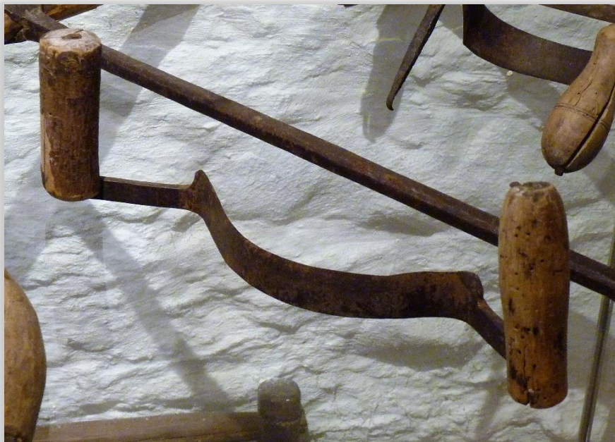
Abbildung 12: Reifmesser waren wichtige Werkzeuge der Holzbearbeitung (Schiffahrtsmuseum Spitz an der Donau).
