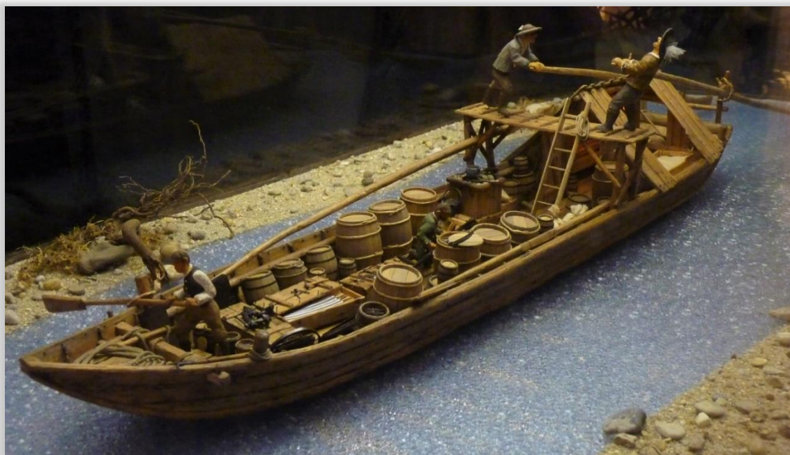
Abbildung 29: Typisch für die Zillen waren ein flacher Boden und geringer Tiefgang, die Steuerruder hatten etwa eine halbe Fahrzeuglänge, Modell im Maßstab 1:20 (Schiffahrtsmuseum Spitz an der Donau).
