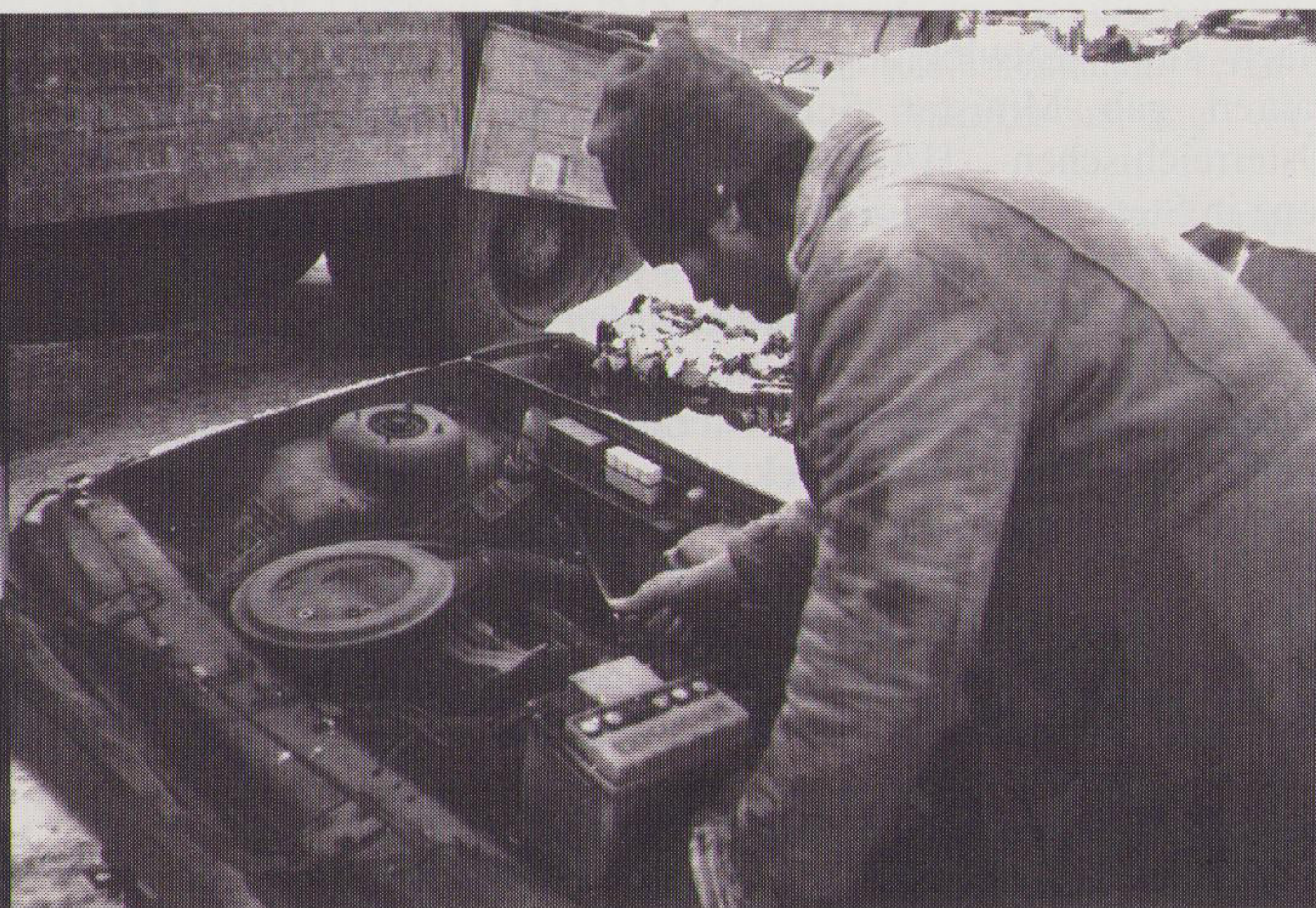
④ Motor und Batterie werden ausgebaut. –
