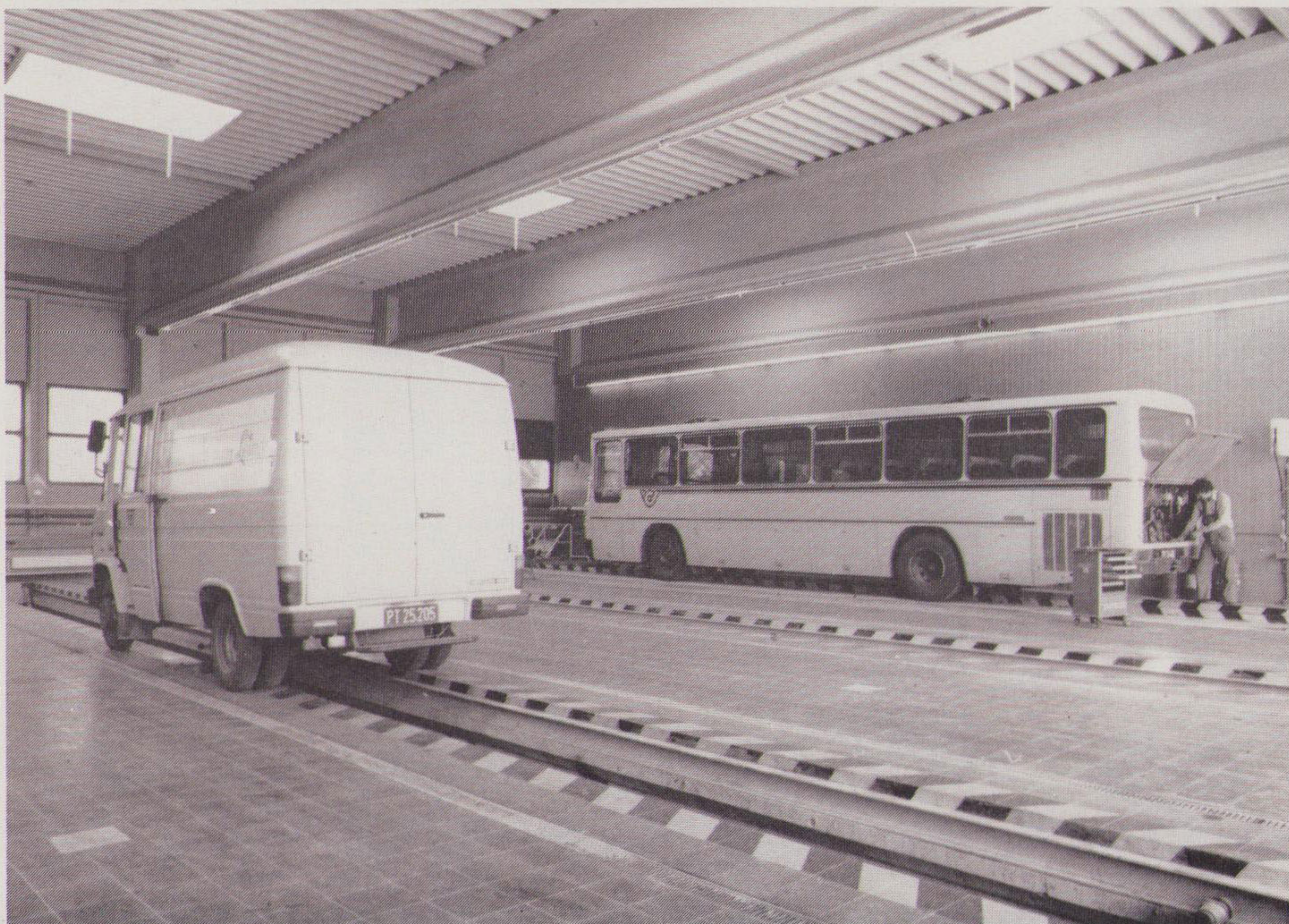
In beiden Einstellhallen für Omnibusse befinden sich zwölf Abstellplätze. Davon sind zwei mit Pflegegruben ausgestattet.
