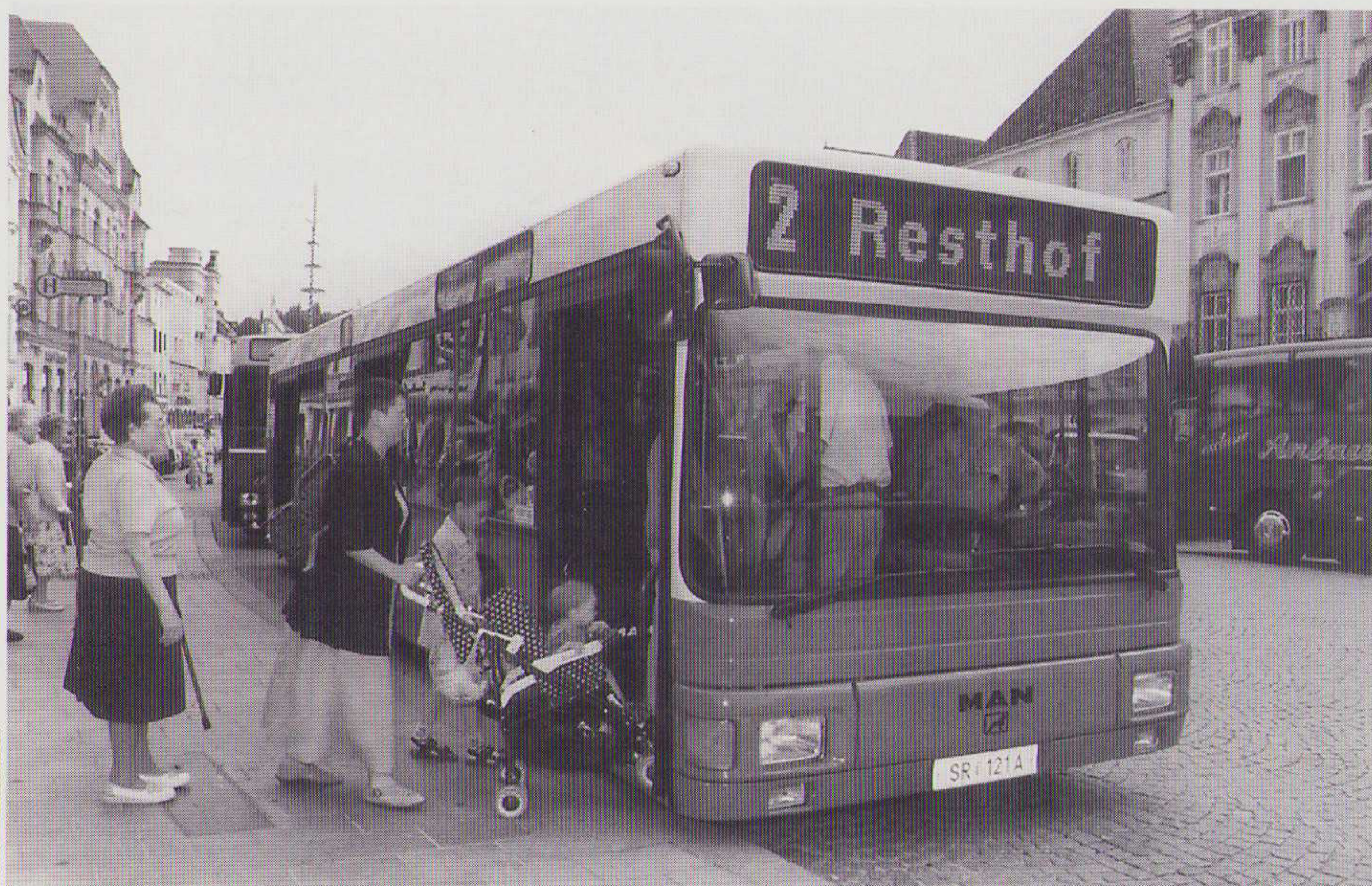
Zwei neue Niederflrbusse erhöhen den Fahrgastkomfort im städt. Linienverkehr. Speziell für ältere Menschen und Mütter mit Kinderwagen ist das stufenfreie Ein- und Aussteigen eine wesentliche Erleichterung.
