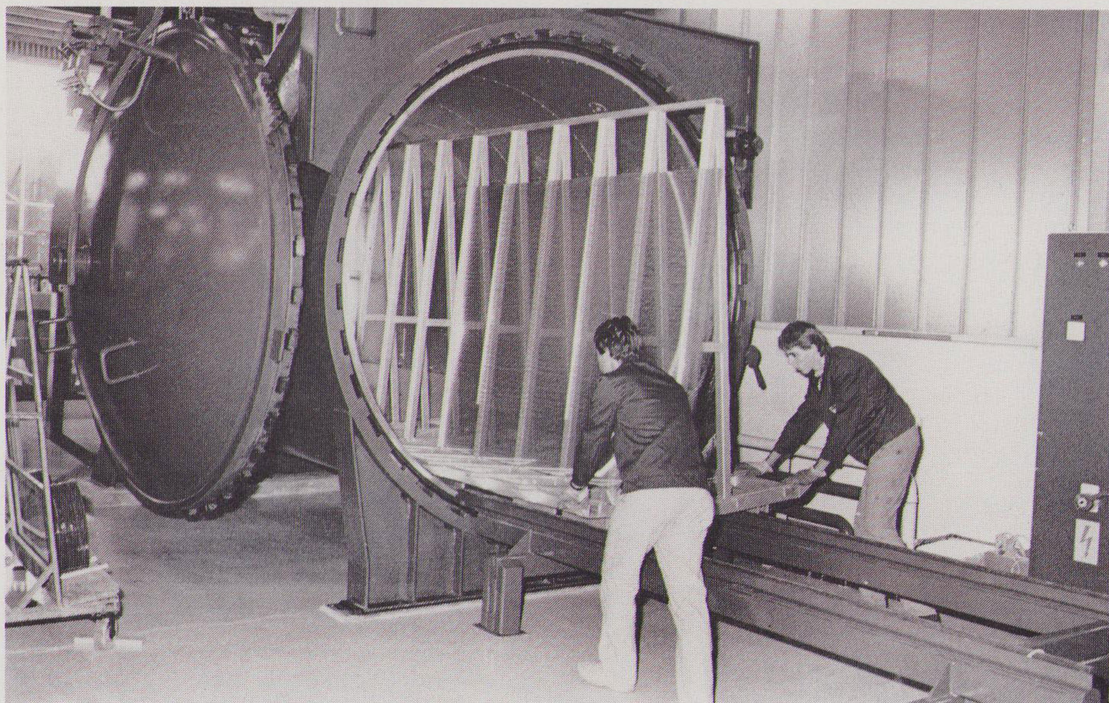
In diesem „Heatshock-Test-Ofen“ der Firma Eckelt wird Fassadenglas höchsten Belastungen ausgesetzt. Platten, die diesen Qualitätstest bestehen, halten auch stärksten Sonnen- und Witterungseinflüssen stand.
