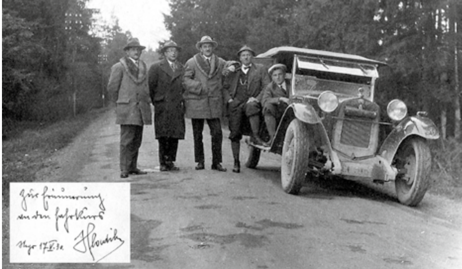
Fahrkurs im Jahr 1930 – das Bild wurde auf der Strecke von Steyr nach Enns gemacht. Damals herrschte noch Linksverkehr. Das Auto ist ein Steyr Typ XII Doppelphaeton. Dieses Fahrzeug war das erste in Steyr, das mittels moderner Fließbandfertigung produziert worden ist.
